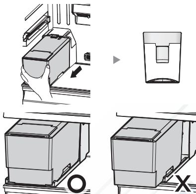
**Закрепите ёмкость для воды на полке внутри холодильника.** В противном случае ёмкость может неправильно работать. Не пользуйтесь холодильником без ёмкости для воды. В противном случае это может отрицательно повлиять на эффективность работы. При креплении ёмкости для воды будьте внимательны, чтобы не были захвачены пальцы.
