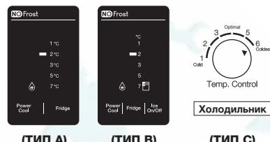
Если продукты в холодильнике не такие холодные, как хотелось бы, или если Вы хотите понизить температуру в морозильной камере холодильника, установите терморегулятор холодильника в положение 5~6 или температуру на модели с дисплеем в положение 1. Если продукты в холодильнике замерзли, или если Вы хотите повысить температуру морозильной камеры, установите терморегулятор холодильника в положение 1~3 или температуру на модели с дисплеем в положение 3~7.
