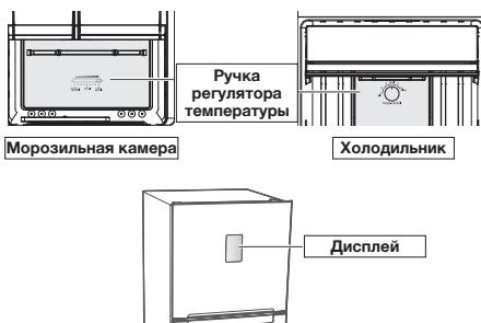
Мы рекомендуем установить терморегулятор морозильной камеры и холодильника в режим Optimal (Оптимальный), чтобы обеспечить стабильную работу прибора.
