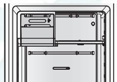
3. Удалите лоток для льда, затем приподнимите полку морозильной камеры, и потяните ее вперед. (Только в модели с опцией лотка для льда)
