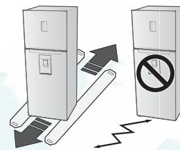
**ПРЕДОСТЕРЕЖЕНИЕ** Будьте внимательны: при перемещении холодильника не повредите защитную ножку. Защитная ножка защищает провод и шланг. Если она повреждена, то холодильник также может быть поврежден. (дополнительно)
